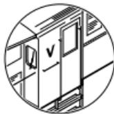
Gehäuse abnehmen (siehe Wartungsarbeiten Punkt 1), Blindstecker (1) abziehen und Digitaldecoder (2) einstecken.
