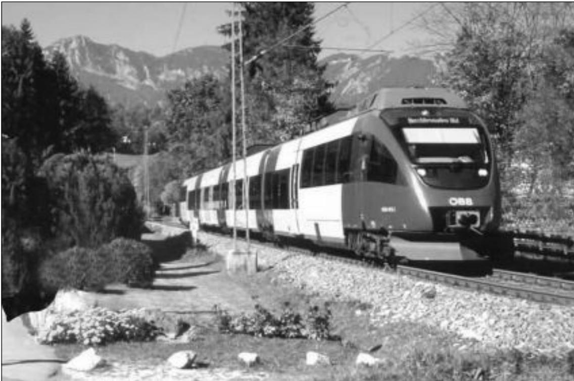
Die vierteiligen Talente der Reihe 4024 werden im S-Bahn-Verkehr der österreichischen Hauptstadt Wien eingesetzt. Die Züge sind insgesamt 66,87 m lang, die Motoren haben zusammen eine Leistung von 1.520 kW. Bei der Konstruktion der Triebwagen der Talent-Familie wurde auch der elektrische Antrieb berücksichtigt. Die österreichischen Bundesbahnen ÖBB sind die erste Bahnver-
