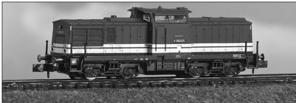
Nach dem Krieg entwickelte die Deutsche Reichsbahn in der DDR ein Programm von Diesellokomotiven, um die zahlreichen noch vorhandenen Dampflokomotiven rasch zu ersetzen. Die mittlere Leistungsklasse sollte mit einem Loktyp mit Mittelführerstand und einer Motorleistung zwischen 480 kW und 880 kW (650 bis 1200 PS) abgedeckt werden.
