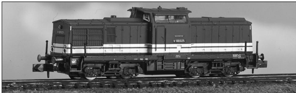
Nach dem Krieg entwickelte die Deutsche Reichsbahn in der DDR ein Programm von Diesellokomotiven, um die zahlreichen noch vorhandenen Dampflokomotiven rasch zu ersetzen. Die mittlere Leistungsklasse sollte mit einem Loktyp mit Mittelführerstand und einer Motorleistung zwischen 480 kW und 880 kW (650 bis 1200 PS) abgedeckt werden.
