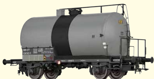
Leichtbaukesselwagen Uerdingen Z [P] "Etra" SBB Betriebs-Nr. 538 539 [P]
