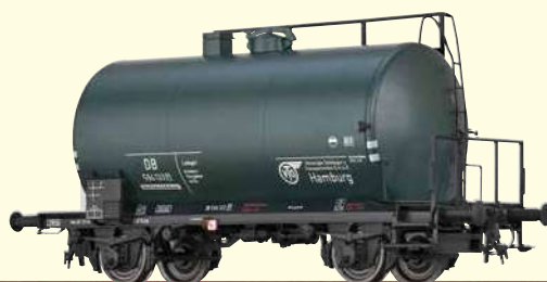
Leichtbaukesselwagen Uerdingen Z [P] "VTG" DB Betriebs-Nr. 594 133 [P]
