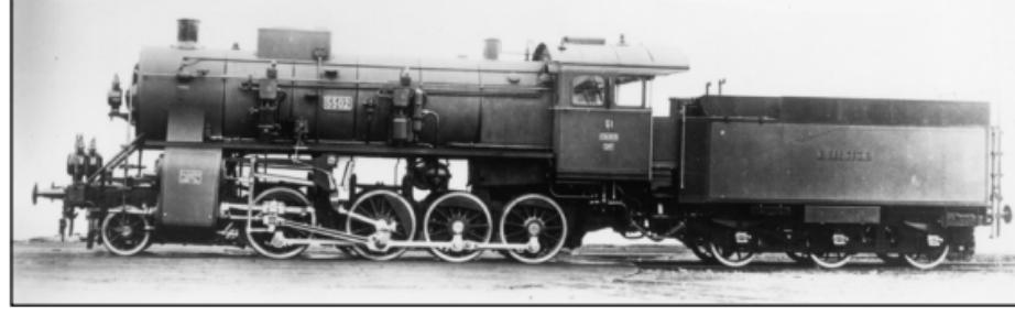
1894 ging die bayerische Staatsbahn von der dreifach gekuppelten Güterzuglok zum Vierkuppler mit vorderer Laufachse über. In dieser Bauart entstand die Lokomotivklasse E 1 in verschiedenen Bauformen, danach ab 1905 die Klasse G 4/5 N; ab 1915 entstand bei Maffei die Klasse G 4/5 H. Mit dieser letzten Version der bayerischen 4/5 gekuppelten Loks entstand die größte, stärkste und modernste deutsche Lokomotive dieser Achsfolge.
