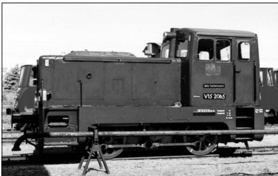
Die Lokomotiven der Baureihe V15 wurden im gesamten Gebiet der Deutschen Reichsbahn eingesetzt. Mit ihnen konnte auf vielen kleineren Bahnhöfen der Rangierdienst rationalisiert werden. Als Nachfolgerin der Köf II entstand bei der DR die Rangierlokomotive V 15. Sie wurde aus einer Industrielokomotive von LKM Babelsberg weiterentwickelt. Nach einer Baumusterlok aus dem Jahr 1958 entstand ab 1959 eine Nullserie von 20 Maschinen, denen ab 1960 die 249 Serienloks der Reihe V 15.20 folgten.
