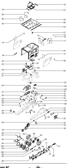
Wechselstrom-Ausführung AC Alternating current model AC
