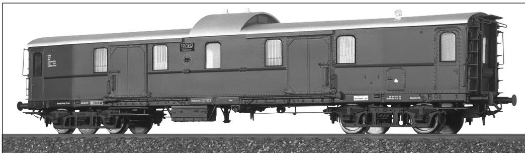
Als sich der Erfolg der eisernen Bauart bei D-Zug-Wagen abzuzeichnen begann, beschaffte die Preußische Staatsbahn auch vierachsige Gepäckwagen in „eiserner Bauart“. Die Hauptabmessungen der bisherigen Wagen in Holzbauart wurden beibehalten, die Konstruktion aber überarbeitet und auf die Verwendung von Eisenprofilen ausgerichtet.
