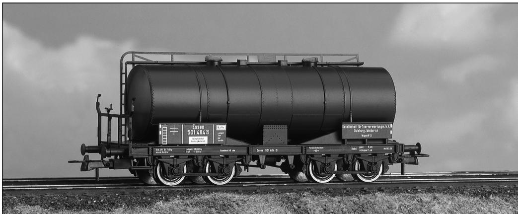
Ab 1922 entstanden Großkesselwagen der Bauart Krupp. Die ersten Exemplare dienten dem Transport von Teer. Fahrzeugtechnisch handelte es sich um zweiachsige Wagen mit vier Radsätzen – eine Bauform zwischen den herkömmlichen Zweiachsern und den heutigen Vierachsern mit Drehgestellen.
